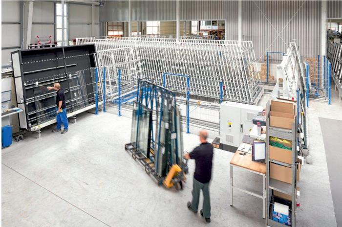
*Ein weiterer zentraler Bestandteil der modernisierten Produktion ist die neue Glassortier- und Kommissionieranlage von Stürtz.*
