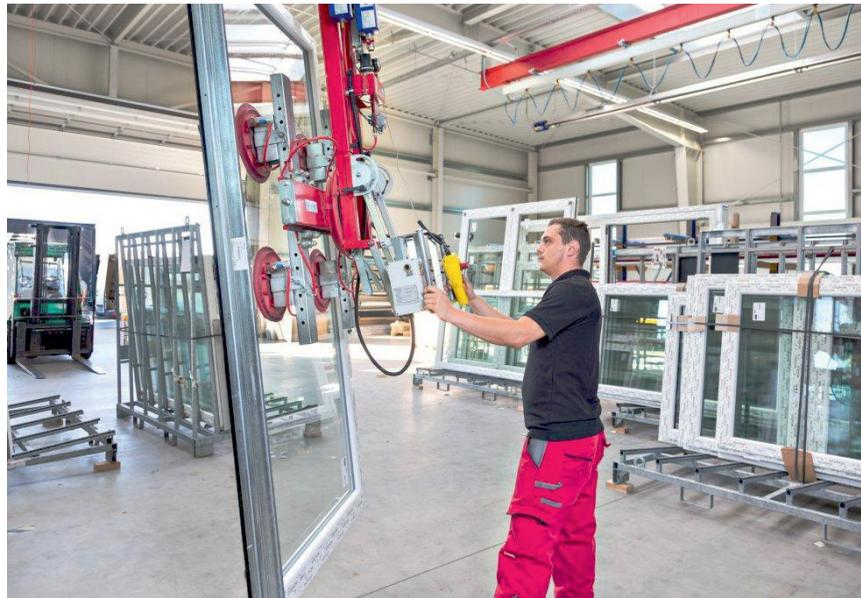
Die Palettierung der Elemente auf die Stahlgestelle erledigt eine Krananlage mit Vakuum-Hebe geräten.
