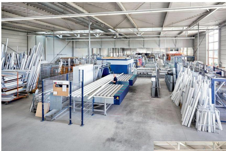
*Eine der Produktionslinien rüstete FensterART mit einem neuen Stab-Bearbeitungszentrum FTB 100 des Herstellers BJM auf.*
